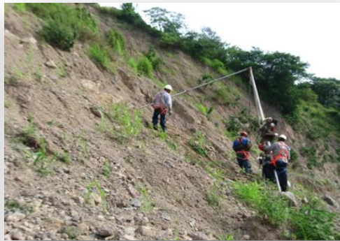
Fotografías 10 y 11. Ejecución de sondeos del tipo Penetración Estándar (SPT) en talud lateral derecho.
