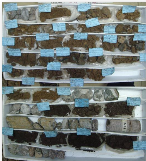
Fotografía 23. Vista de muestras recuperadas de sondeo rotativo S-2R.
