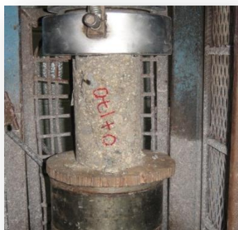
Fotografías 32, 33, 34, 35 y 36. Mostrando pruebas realizadas a núcleos extraídos en la ribera del Río.
