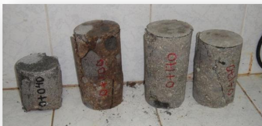
Fotografías 32, 33, 34, 35 y 36. Mostrando pruebas realizadas a núcleos extraídos en la ribera del Río.
