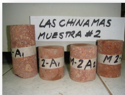
Fotografía 29. Muestras que no pudieron ser sometidas a Ensayos de Resistencia a la Compresión
