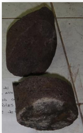
Fotografía 38. Mostrando material extraído de la parte media del cuerpo del talud, con el objeto de definir profundidades de los anclajes de la malla de doble torsión proyectada en el sector medio del talud
