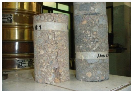
Fotografías 30 y 31. Muestras sometidas a Ensayos de Resistencia a la Compresión de las muestras 3 y 2.
