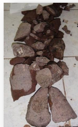
Fotografía 38. Mostrando material extraído de la parte media del cuerpo del talud, con el objeto de definir profundidades de los anclajes de la malla de doble torsión proyectada en el sector medio del talud
