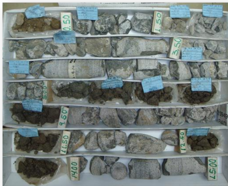
Fotografía 22. Vista de muestras recuperadas de sondeo S-1R.
