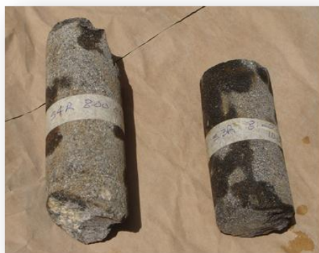
Fotografía 27. Muestras sometidas a Ensayos de Resistencia a la Compresión.
