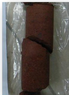
Fotografías 30 y 31. Muestras sometidas a Ensayos de Resistencia a la Compresión de las muestras 3 y 2.
